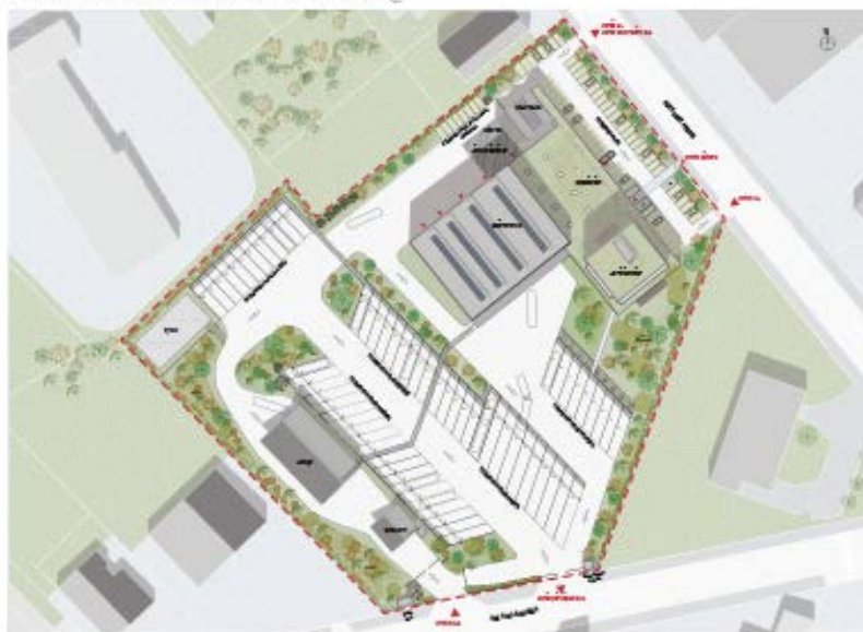
Plan masse, intégrant du projet dans le site, principaux passages et sens de circulation | Ech. 1/400
